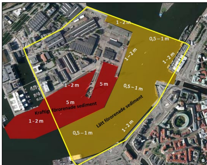
Figur 18: Illustration av föroreningssituationen i vattenområdet med angivna mäktigheter av förorenade sediment. Bild från Gång- och cykelbroar över Göta älv – Merkostnader för mark och sedimentsanering (Relement på uppdrag av trafikkontoret 2020).
