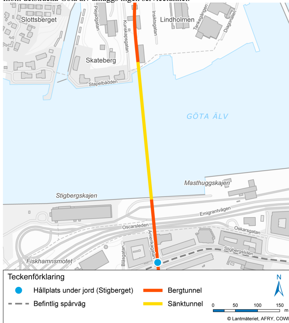
Figur 7. Sänktunnel i Göta älv och dess möten med bergtunnel på respektive sida av älven. Hållplatsens placering visas i ungefärligt läge då utredning om exakt placering pågår (Illustration: AFRY).
