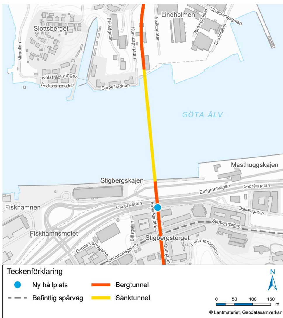
Figur 19. Sänktunnel i Göta älv och dess möten med bergtunnel på respektive sida av Göta älv (Illustration: AFRY).
