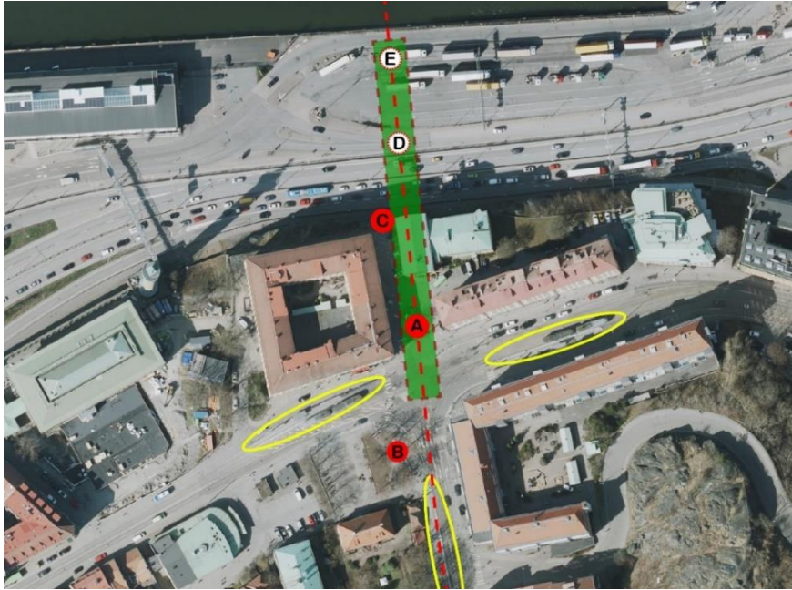
Figur 21. Möjliga och studerade uppgångar (A, B och C) från hållplatsen mot Stigbergstorget. I bilden ses även eventuellt framtida hållplatsläge för buss (D) samt framtida koppling till Stigbergskajen och till eventuell framtida färjehållplats (E). D och E ingår ej i aktuellt projekt Lindholmsförbindelsen. Grön rektangel visar möjlig placering av hållplats under mark. Gula ellipser visar befintliga lägen för spårvagnshållplatser (Illustration: AFRY).
