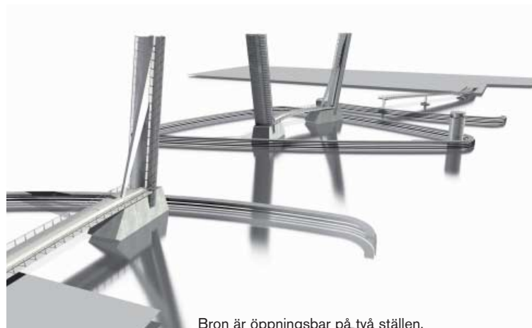
Bron är öppningsbar på två ställen.
