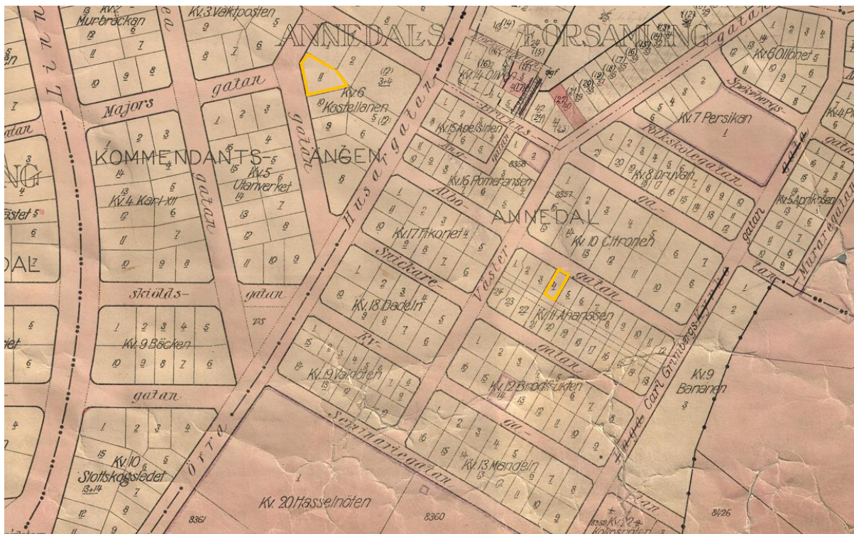
Linnéstadens - Annedals standardiserade tomtindelning mellan ca 12,5m, 15m och 22,5m i bredd
